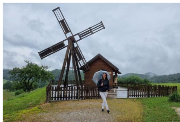
Posebno obliko ohranjanja naše dediščine predstavlja mlin na veter v Makolah. Lesena stavba mlina ima v svoji notranjosti mlinsko napravo z mlinskima kamnoma, ki ju poganja vetrnica. Pogonski del mlina z vetrnico je vrtljiv, saj se mora vetrnica vedno usmerjati v smer pihanja vetra.
